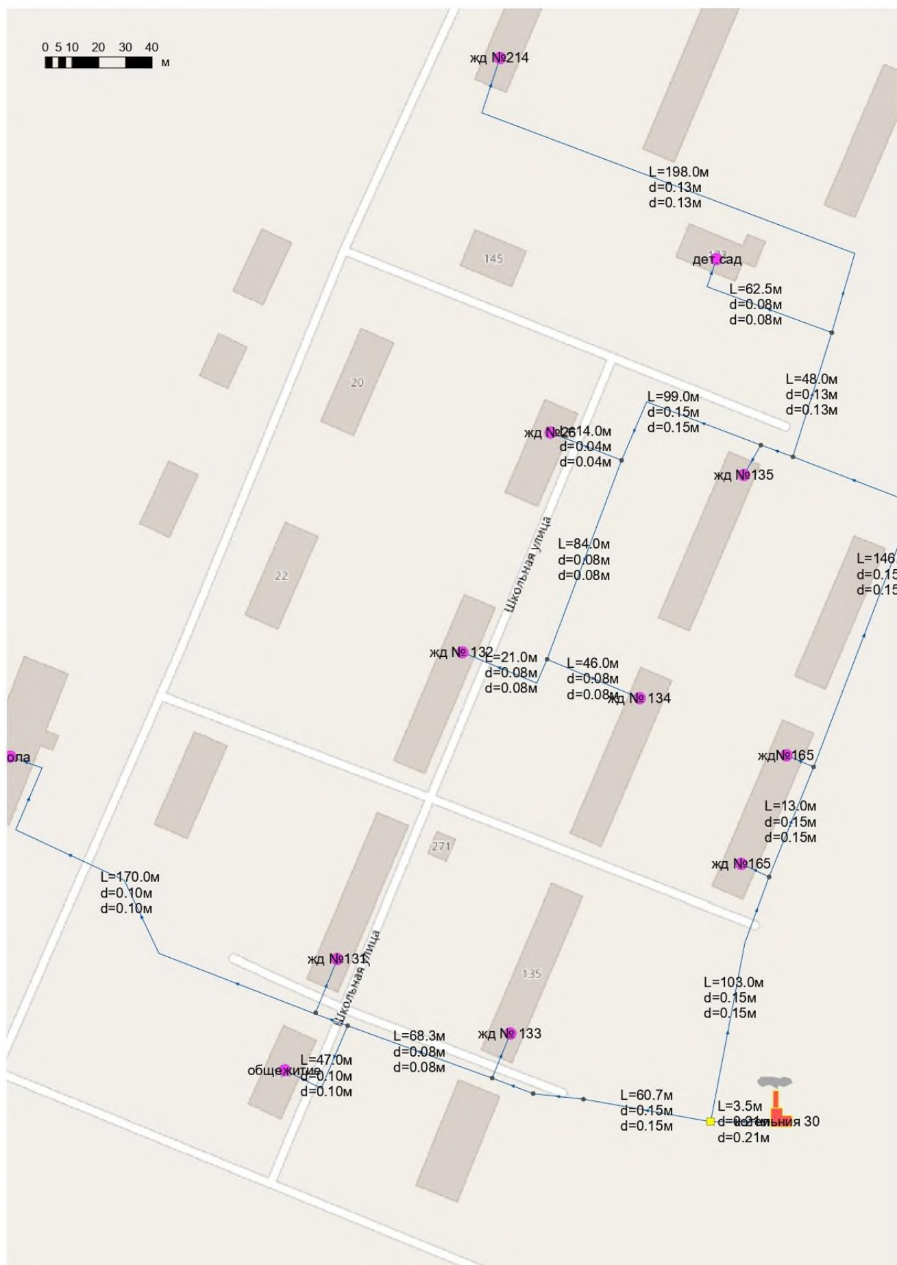
Рис. 2.5 – Схема теплоснабжения села Ляличи от котельной № 1/30
