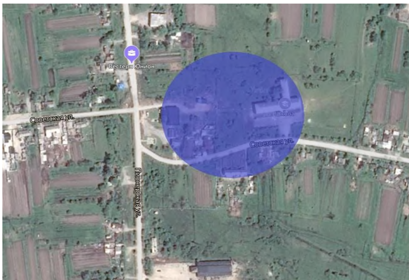
Рис. 2.1 – Зона действия теплоснабжения котельной № 1/33 села Абрамовка
