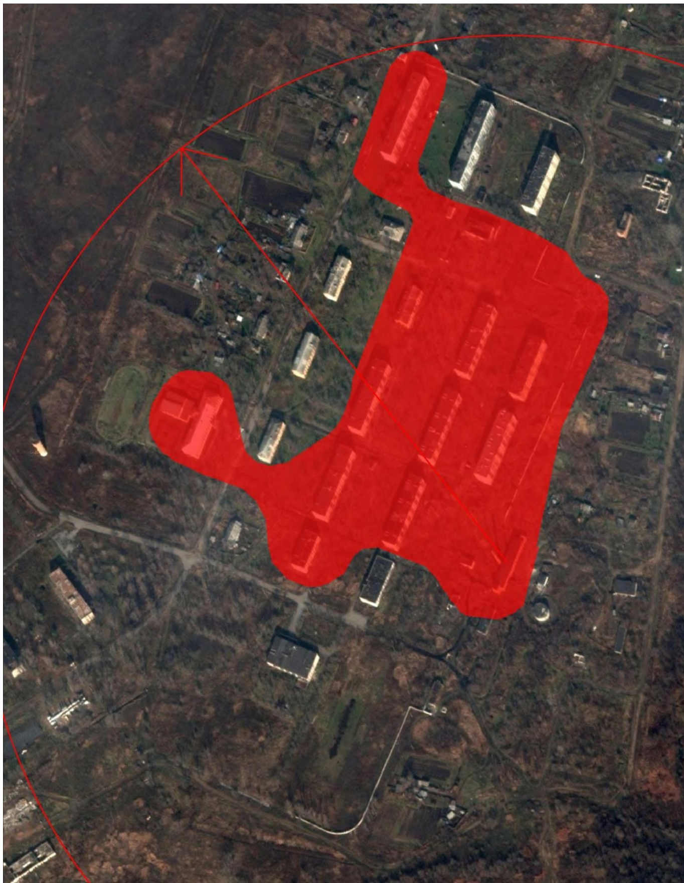
Рис. 5.2 – Радиус эффективного теплоснабжения с.Ляличи
