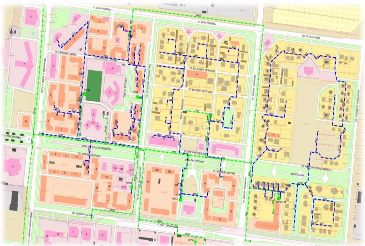
Рисунок 6 – Пример отображения трассировки газопроводов в населенном пункте
