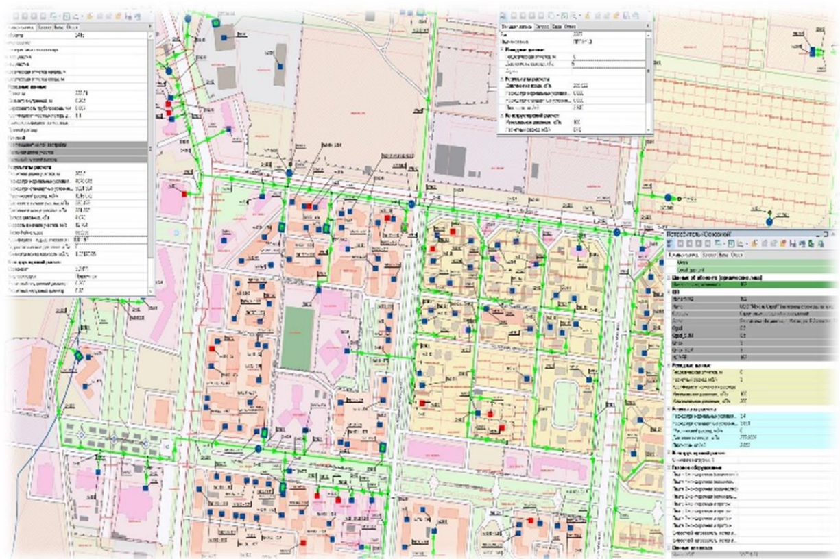
Рисунок 5 - Пример отражения базы данных элемента системы газоснабжения
