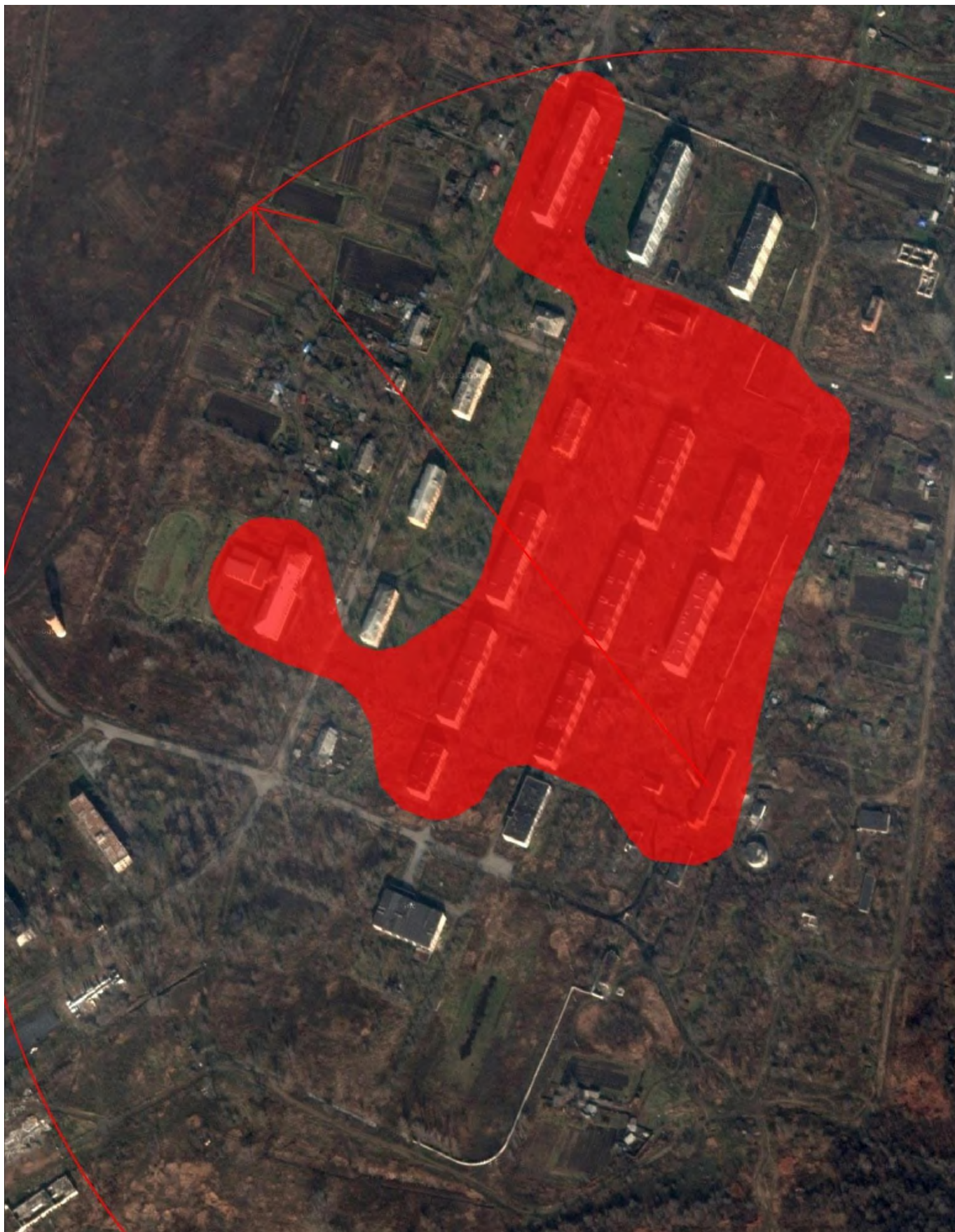
Рис. 5.2 – Радиус эффективного теплоснабжения с.Ляличи
