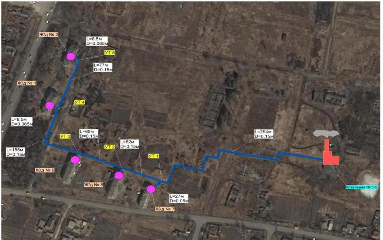
Рис. 2.1.1.4 - Схема теплоснабжения от котельной № 1/5
