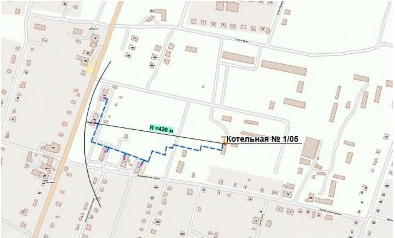
Рисунок 2.5.4 - Радиус эффективного теплоснабжения котельной № 1/5
