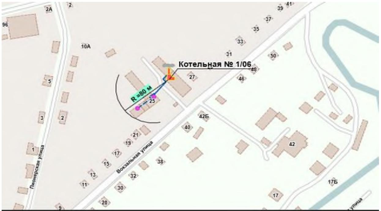
Рисунок 2.5.5 - Радиус эффективного теплоснабжения котельной № 1/6
