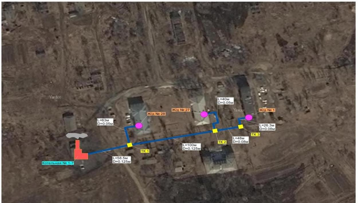
Рис. 2.1.1.5 – Схема теплоснабжения от котельной № АМК 1/7
