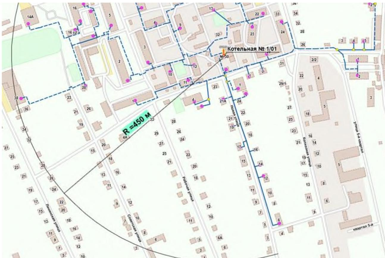
Рисунок 2.5.1 - Радиус эффективного теплоснабжения котельной № 1/1
