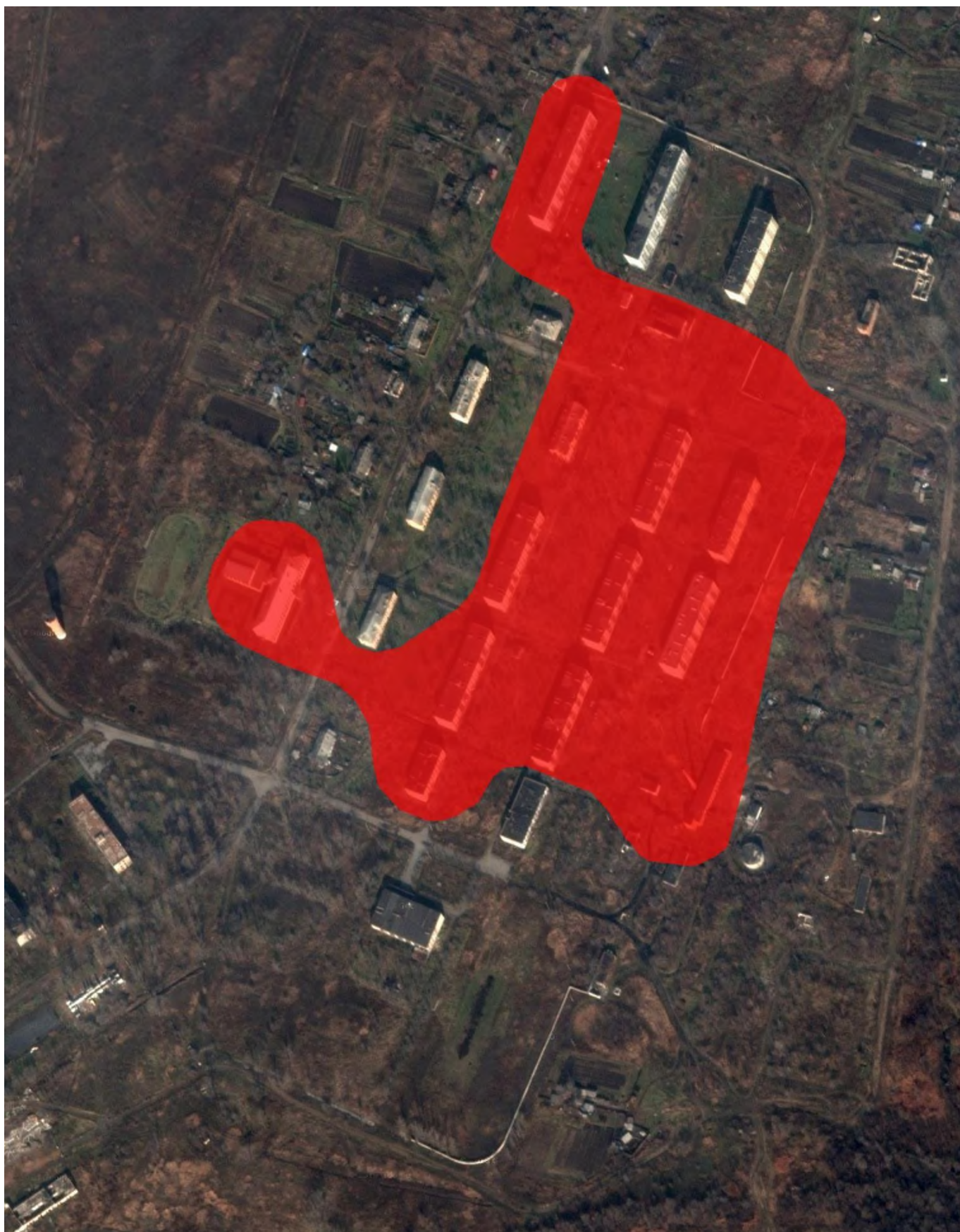
Рис. 2.1 – Зона действия теплоснабжения котельной № 1/30 села Ляличи
