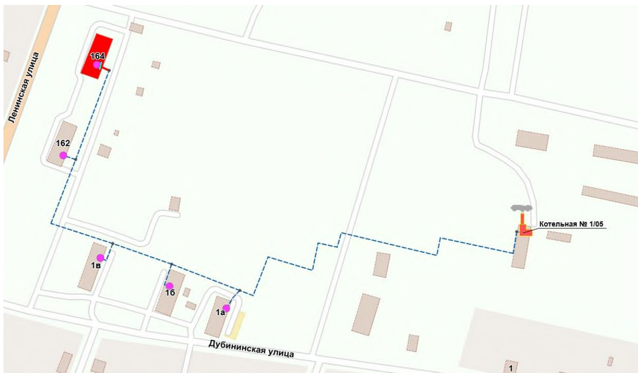
Рисунок 34 - Визуализация отключения запорной арматуры на котельной 1/5
