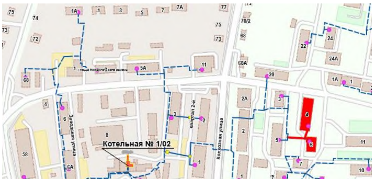
Рисунок 32 - Визуализация отключения запорной арматуры на котельной 1/2
